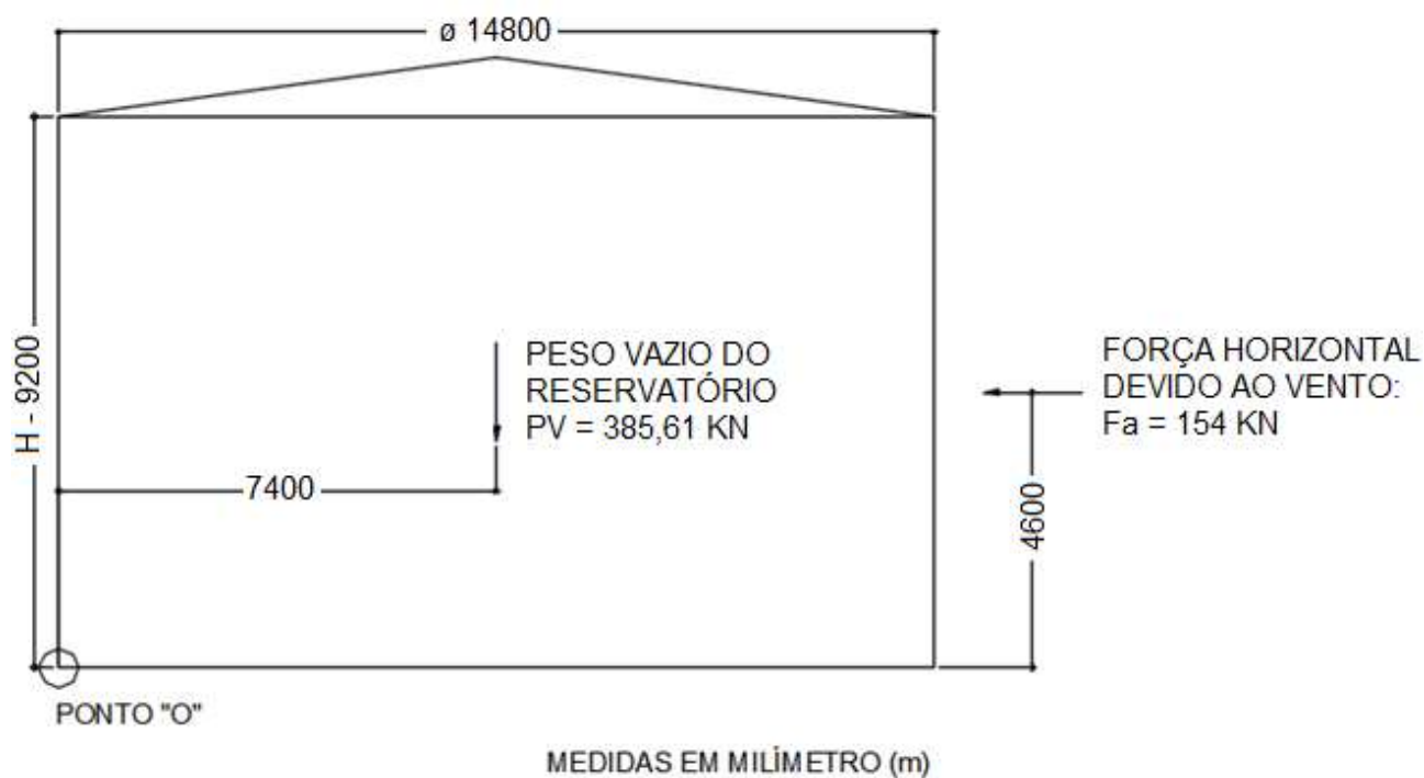
Figura 11 – Esquema de forças para a verificação do tombamento
