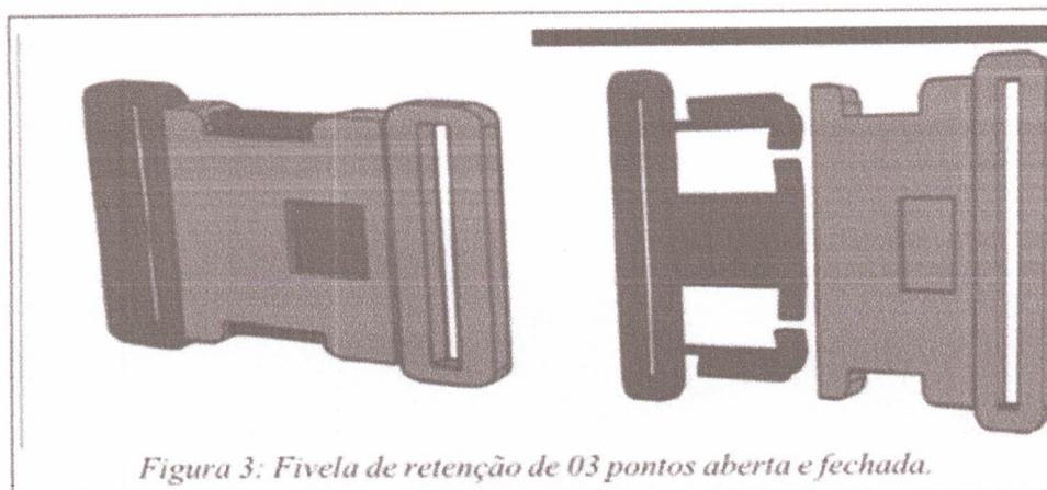
Figura 3: Fivela de retenção de 03 pontos aberta e fechada.
